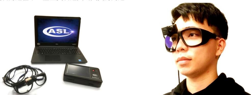
圖 1 ASL Mobile 移動式眼動儀與攜帶式觸控顯示器 DTU 與筆記型電腦 圖片來源：(本研究拍攝)
